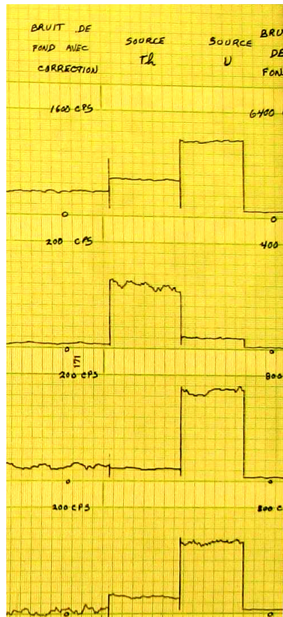
Figure 12. Exemple de calibration à partir de sources radioactives, levé 22C/04 (1979). Retour au texte
